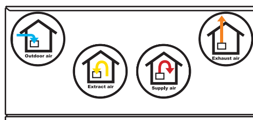
Fig. 5 Aggregat sett ovenfra - Luftretning
